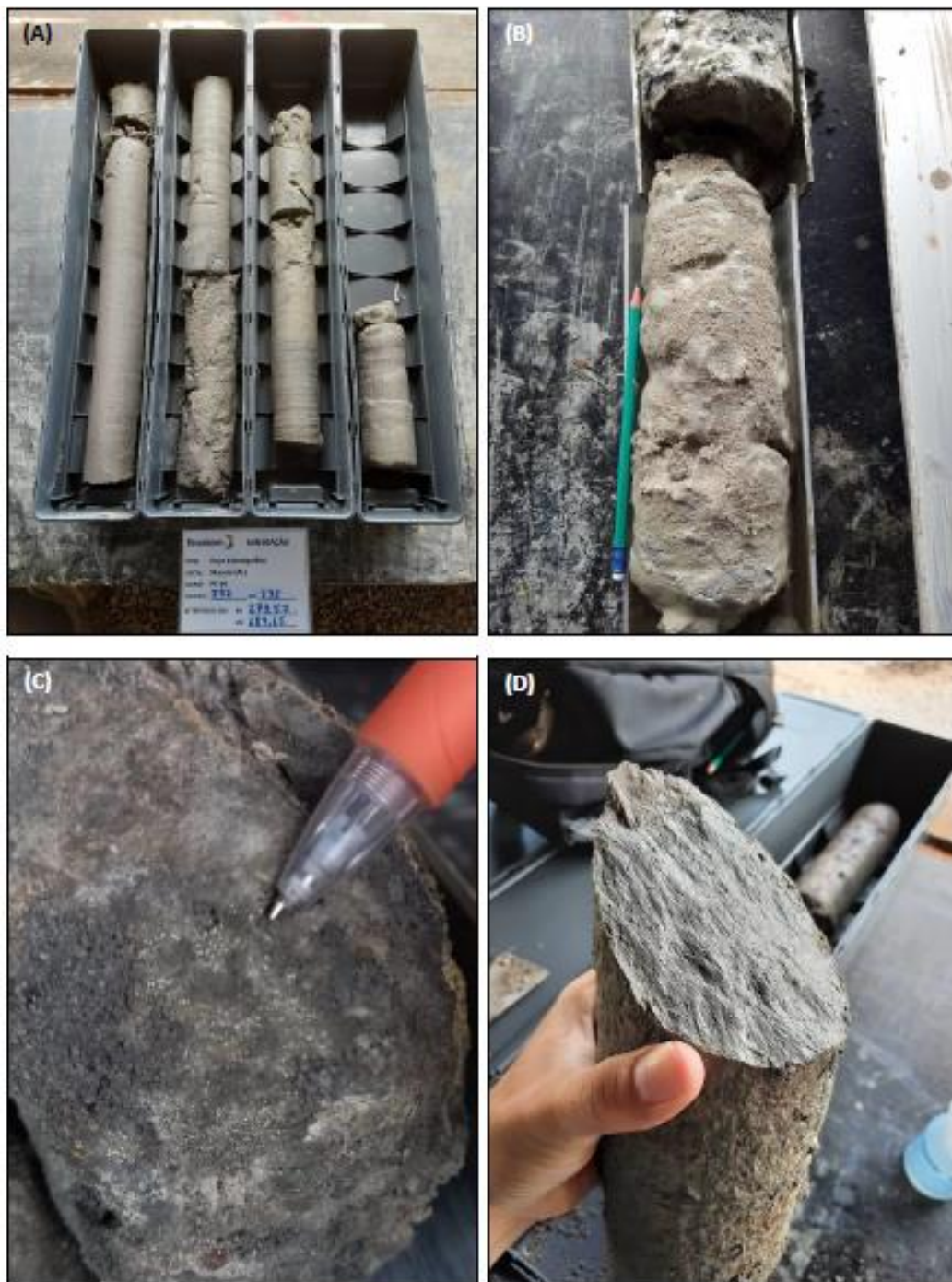
Figura 14 - (A) Intervalo 279,57 m até 284,65 m mostrando o aspecto inconsolidado dos intervalos arenosos; (B) Aspecto do arenito/areia inconsolidado (260,66 m); (C) Nível sulfetado em meio a calcarenitos (303,40 m), e; (D) Manobra TEST 91 (intervalo de 297,40 m até 303,40 m), mostrando testemunho com passagens de arenitos e calcarenitos, consolidadas a semi-consolidadas.
