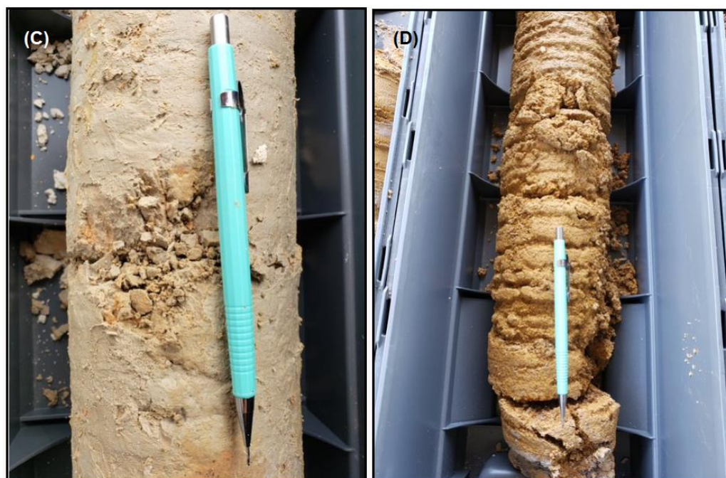
Figura 10 - (C) Arenito fino, friável com tons amarelados na profundidade 35,50 m e (D) Arenito com granulação grossa e aspecto sapolitizado, característico do Grupo Barreiras na profundidade 41,50 m.
