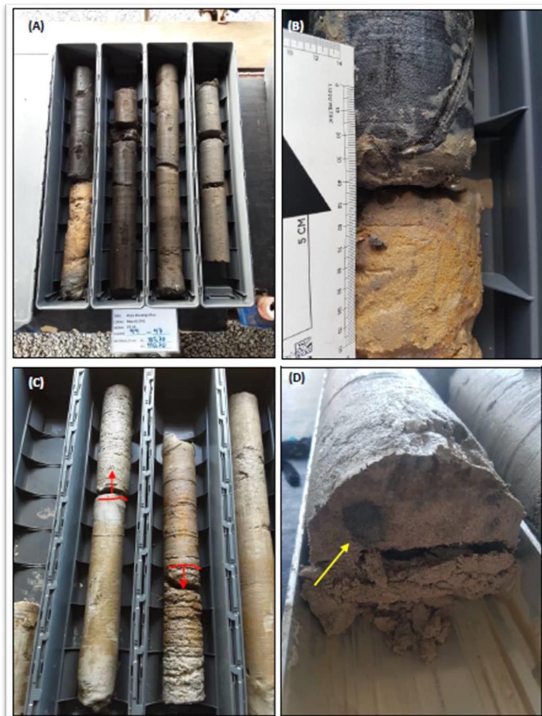
Figura 11 - (A) Zona de contato entre sedimentos arenosos do Grupo Barreiras (amarelado) com sedimentos siltico arenosos da Fm. Marituba (negro); (B) detalhe do contato da fotografia anterior, entre as unidades Barreiras e Marituba; (C) Intervalo centimétrico de arenito conglomerático na Fm. Marituba (setas em vermelho), e; (D) fragmentos de arenito negro (seta amarela) em meio a arenitos finos a médios na Fm. Marituba (115,55 m).
