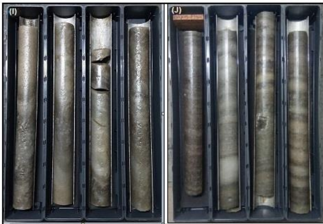
Figura 24 - (I) Intervalo de 1121,27 m até 1124,71 m exibindo camada de sal-gema cinza homogêneo; (J) Intervalo de 1090,58 m a 1094,07 m exibindo sal-gema cinza bandado.
