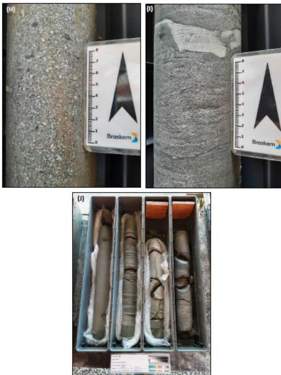
Figura 18 - (H) Arenito lítico exibindo litoclastos subarredondados milimétricos (621,45 m); (I) Arenito lítico, exibindo intercalação irregular de calcarenito (670,70 m); (J) Intervalo entre 680,83 m até 684,39 m exibindo arenitos conglomeráticos (topo) gradando a arenitos médios a grossos e em seguida voltando para arenitos conglomeráticos (base).
