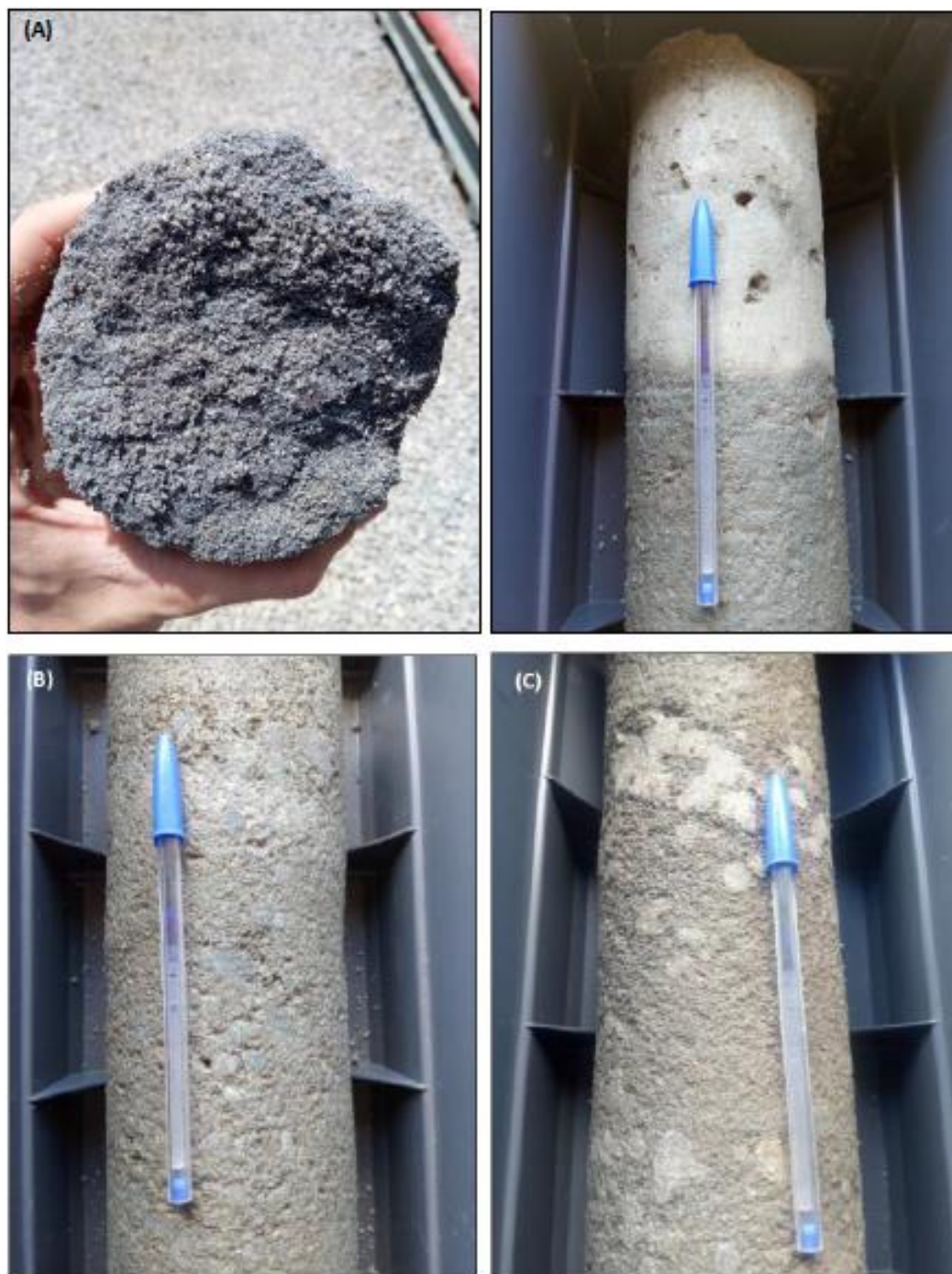
Figura 18 - Testemunhos pertencentes a Formação Poção: (A) Arenito cinza escuro, carbonático, friável (375,95 m), e; (B) Arenito conglomerático (Para-conglomerado) cinza claro, formado por grânulos de quartzo e litoclastos de rocha máfica (407,73 m); (C) Arenito conglomerático com coquina (415,35 m). (D) Contato entre arenito cinza escuro com calcarenito bege (384,05 m).
