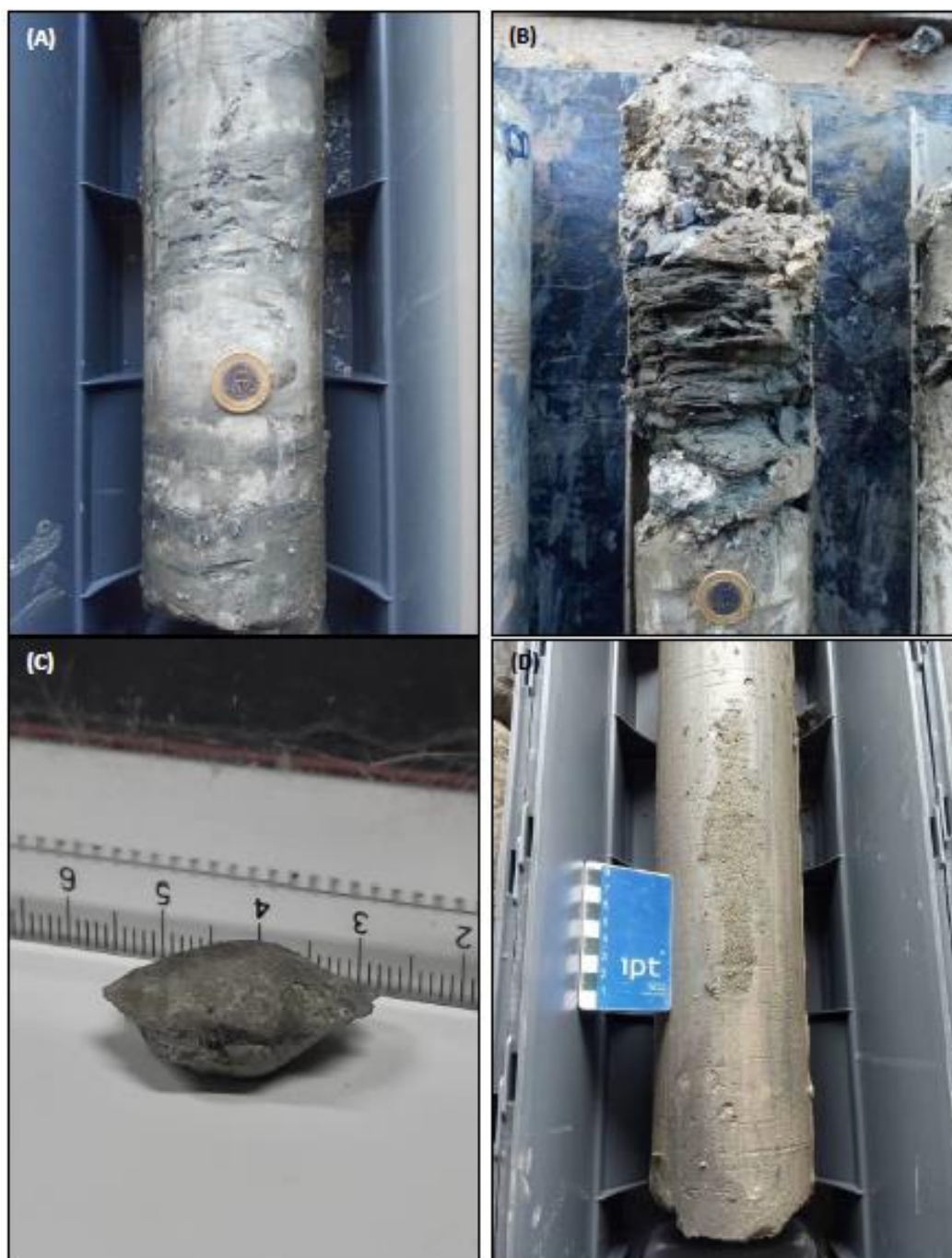
Figura 13 - (A) Calcarenito/Calcário com intercalações de margas esverdeadas (201,64 m); (B) Argilito cinza escuro/esverdeado com nódulos milimétricos de calcário (204,92 m); (C) fóssil de molusco bivalve, em meio a calcarenito cinza fino a grosso inconsolidado (227,75 m), e; (D) Arenito muito fino a fino, com matriz quartzosa, bem selecionado, com grãos subarredondados (259,76 m).
