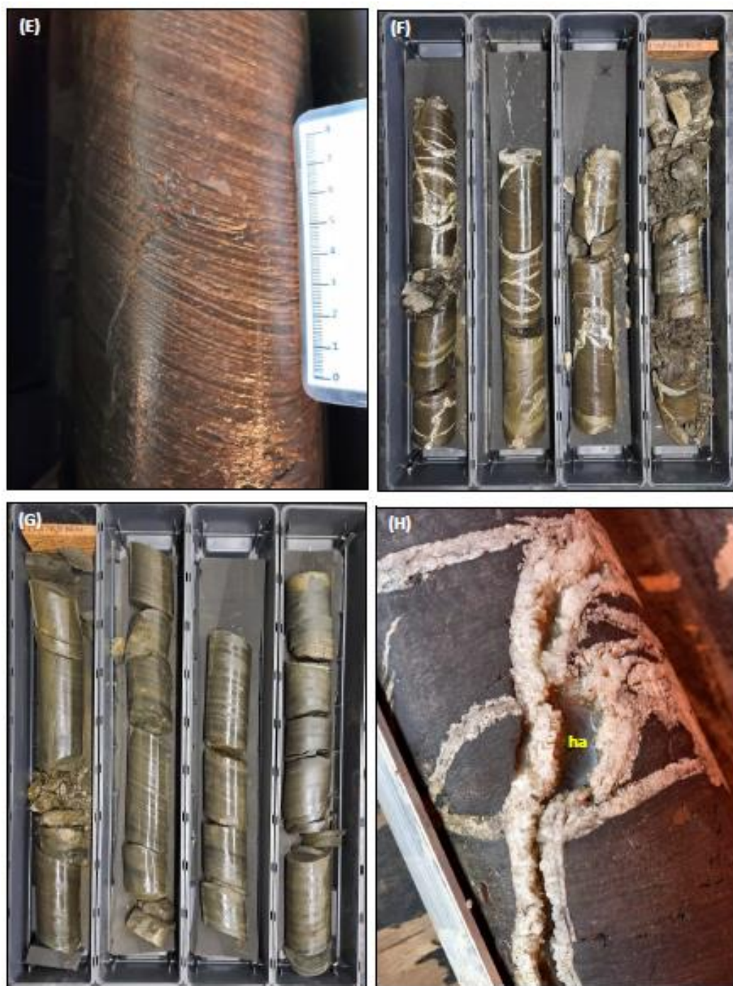
Figura 22 - (E) detalhe do S_0 , sublinhado pela intercalação milimétrica de argilito e calcário, típicos dos folhelhos do Membro Tabuleiro dos Martins (875,55m); (F) Intervalo de 907,41 m até 910,05 m exibindo intercalações entre folhelhos (cinza-escuro) e argilito recortados por fraturas preenchidas por calcita; (G) Intervalo de 885,94 m até 889,24 m exibindo intercalações entre folhelhos (cinza-escuro), calcário bege e arenito cinza-claro, e; (H) Detalhe da fratura preenchida por calcita com halita (ha) na parte central do preenchimento – 912,70 m.
