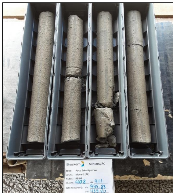
Figura 35 - Foto dos testemunhos do trecho selecionado, arenito cinza com poucas fraturas horizontais, aparentemente induzidas pela operação e manuseio dos testemunhos.
