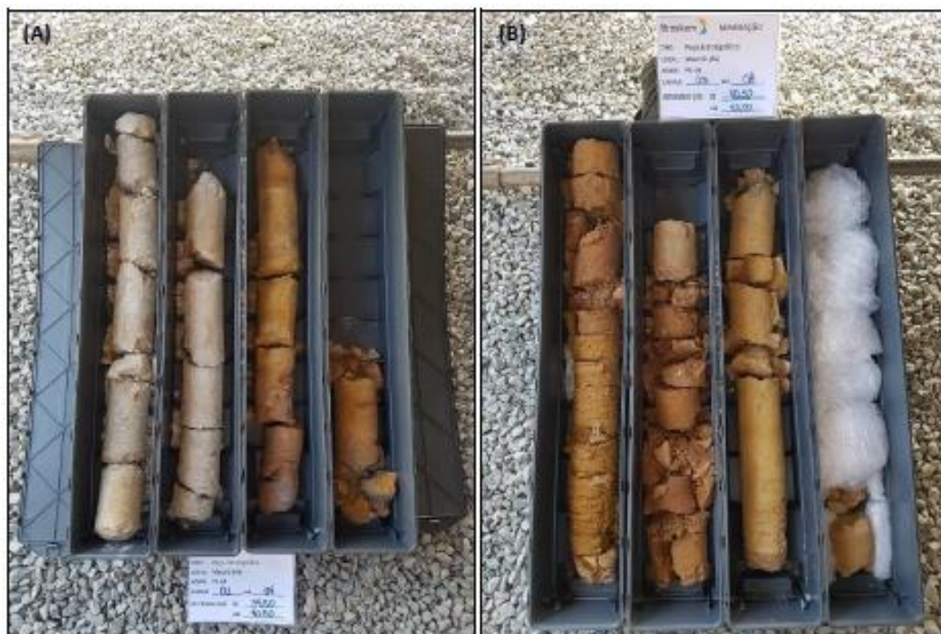
Figura 9 - (A) Registro fotográfico padrão dos testemunhos prontos para armazenamento, após descrição geológica (caixas e profundidades indicadas) e (B) Aspecto frágil, inconsolidado, dos sedimentos constituintes do Grupo Barreiras.
