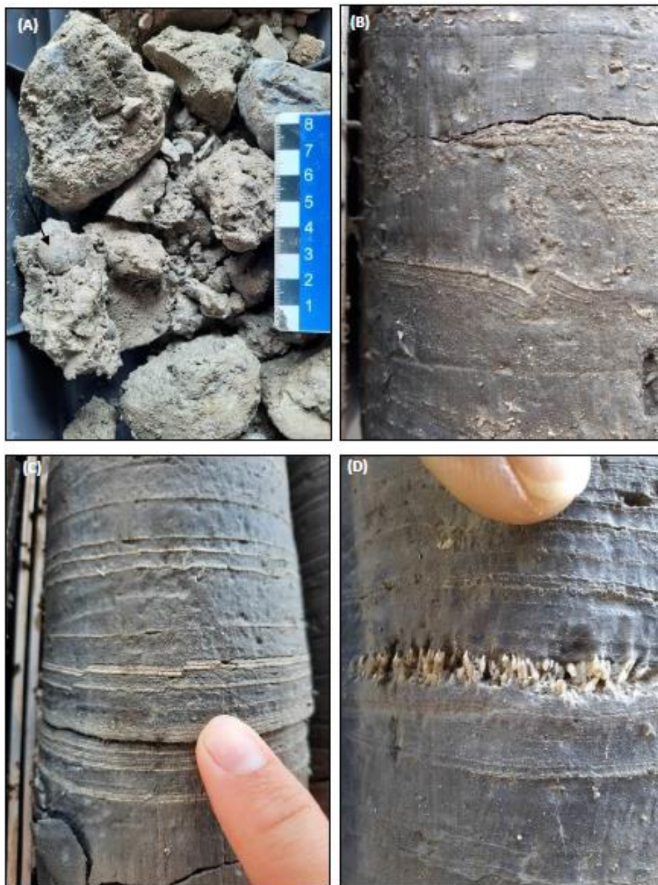
Figura 15 - (A) Calcarenito fossilífero (seta) fraturado (306,60 m); (B) Estruturas sin -sedimentares (microlaminações e microdobras) em argilito calcífero com S_0 sublinhado por “linhas” de calcarenito; (C) Estruturas sin -sedimentares na forma de micro-falhas (intervalo 321-327 m), e; (D) Cavidade preenchida por cristais de calcita do tipo dente de cão” (322,70 m).
