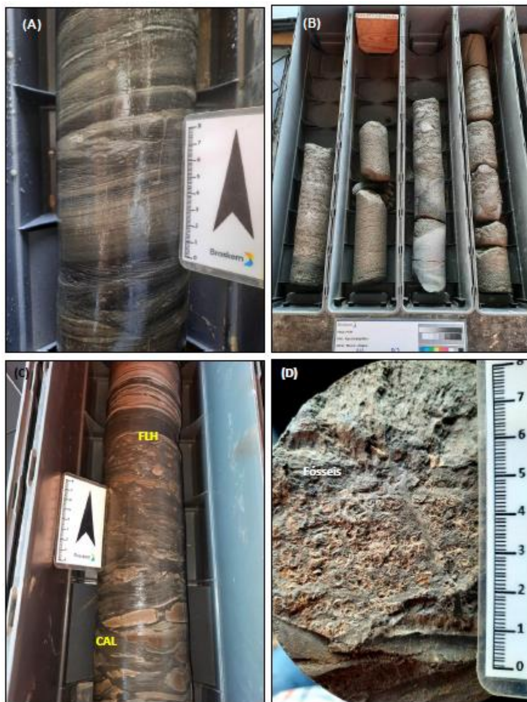
Figura 22 - (A) Testemunho típico do Membro Tabuleiro dos Martins, exibindo S_0 marcante e penetrativo, com estruturas sin -sedimentares de slump (768,25 m); (B) Intervalo de 769,50 m até 772,08 m exibindo interdigitação de arenito conglomerático e conglomerado da Formação Poção; (C) Brecha sedimentar caracterizada por clastos de calcário (CAL) cimentados por folhelho (FLH) preto (812,20 m), e; (D) Detalhe da ocorrência de fósseis em meio a camada de calcário (837,74 m).
