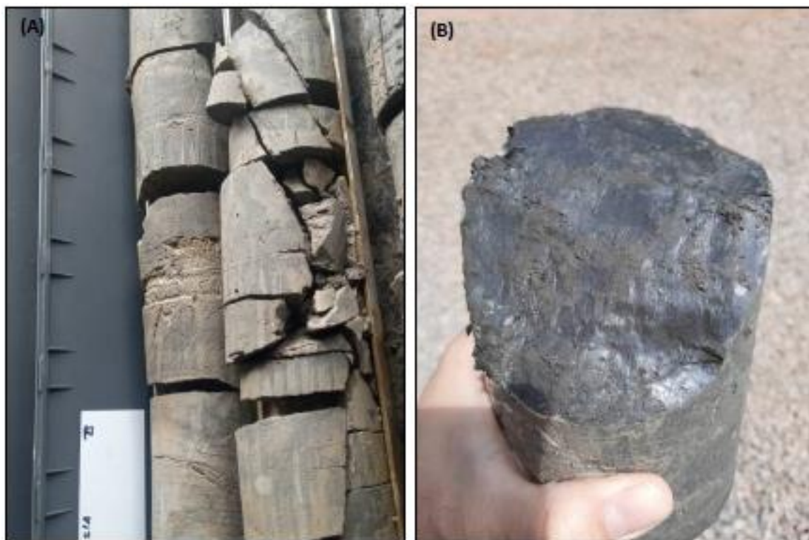
Figura 16 - (A) Sistema de fraturas entre 313,76 m e 314,09 m desenvolvidos em calcilutitos, e; (B) Plano de fratura/espelho desenvolvido em marga com presença de indicadores cinemáticos (estrias e steps ) em 316,96 m.
