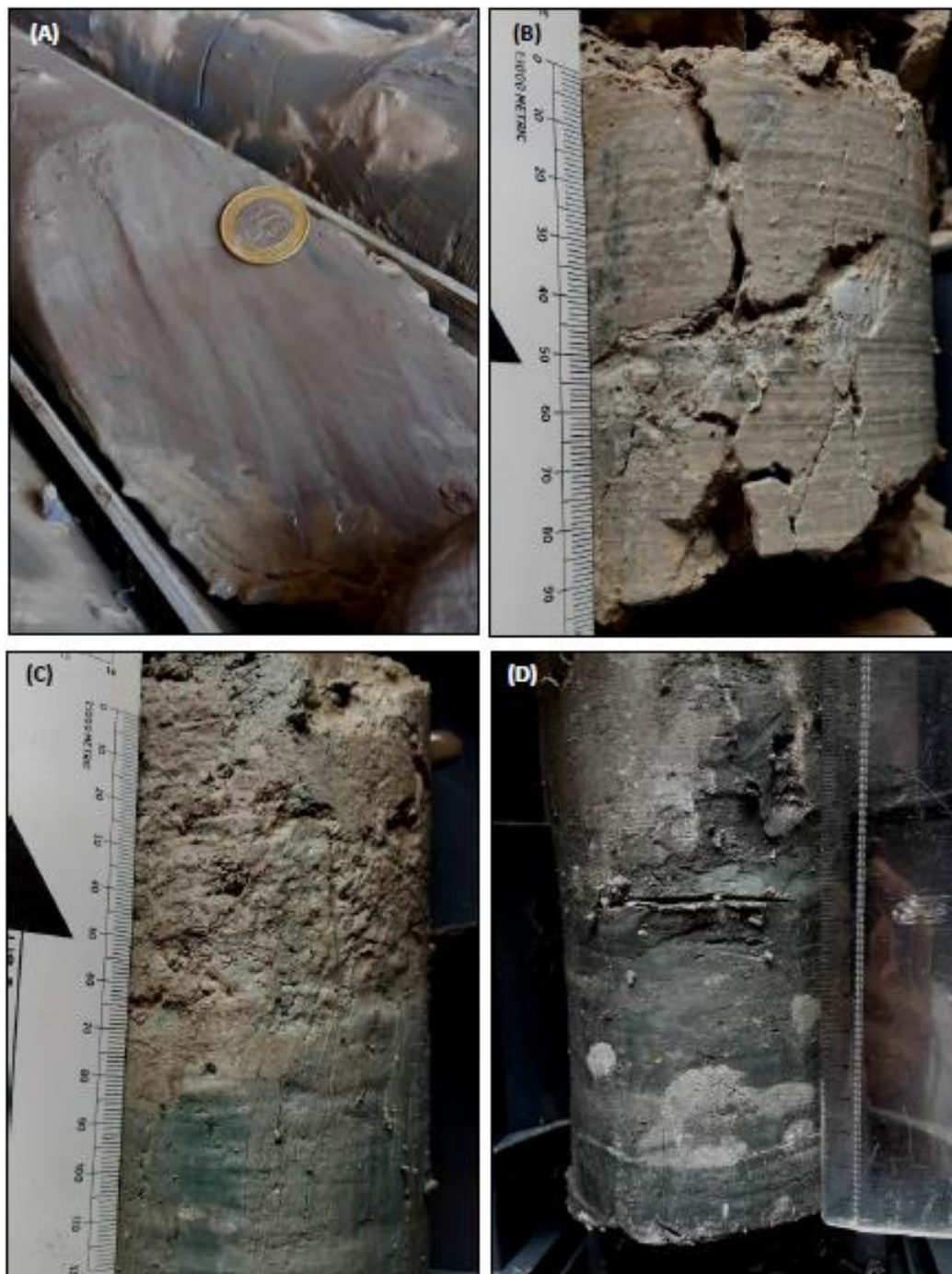
Figura 12 - (A) Plano de fratura com estriaes em marga “chocolate” (168,00 m); (B) Calcarenito intensamente fraturado (170,50 m); (C) Contato calcilutito cinza escuro esverdeado e calcarenito cinza claro (177,47 m), e; (D) Intercalação de calcilutito cinza esverdeado e em meio a camada de calcarenito (188,92 m).
