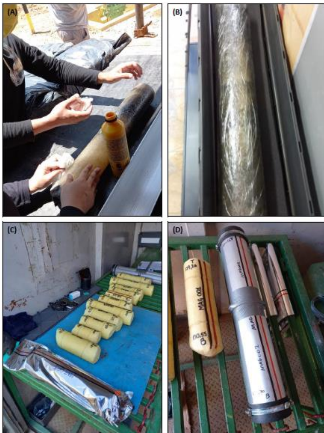
Figura 25 - (A) Etapa de preparação dos testemunhos de sal-gema envolvendo limpeza do fluido de perfuração e aplicação da vaselina; (B) Detalhe do testemunho embalado em plástico filme; (C) Amostra parafinadas e embaladas com sacola de alumínio selada, e; (D) Detalhe das amostras preparadas com cera e embaladas com tubo de alumínio.
