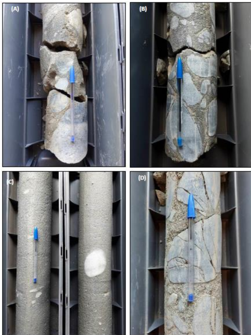
Figura 21 - (A) Conglomerado composto por blocos de granito/granodiorito arredondados (454,63 m); (B) Ortoconglomerado exibindo litoclastos subarredondados formando o arcabouço da rocha (462,10 m); (C) Paraconglomerado com arcabouço de arenitos e litoclastos dispersos (473,60 m); (D) Ortoconglomerados típico formados por litoclastos de granito/granodiorito arredondados e fraturados (481,92 m).
