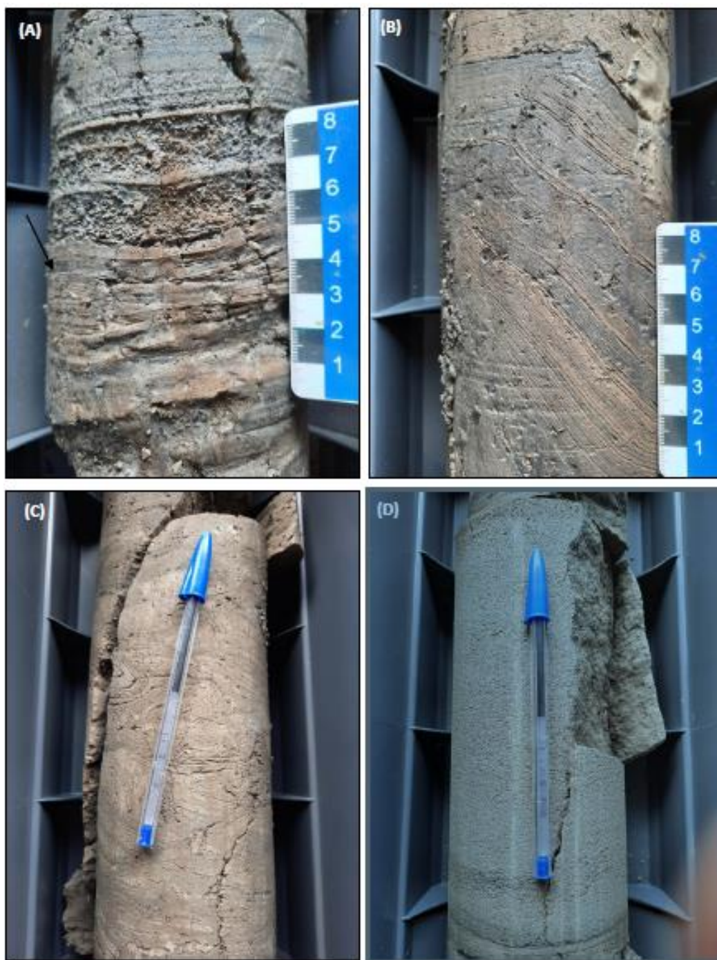
Figura 17 - Testemunhos pertencentes a Formação Muribeca (Membro Ibura): (A) Calcário laminado com feições de dissolução (336,44 m); (B) Calcilutito laminado com níveis milimétricos carbonáticos marcando o S_0 , com inclinação de 42^\circ em relação ao eixo do testemunho (343,99 m); (C) Plano de fratura em calcilutito exibindo feições de slump micro dobrado (350,15 m), e; (D) Calcarenito maciço (354,50 m).
