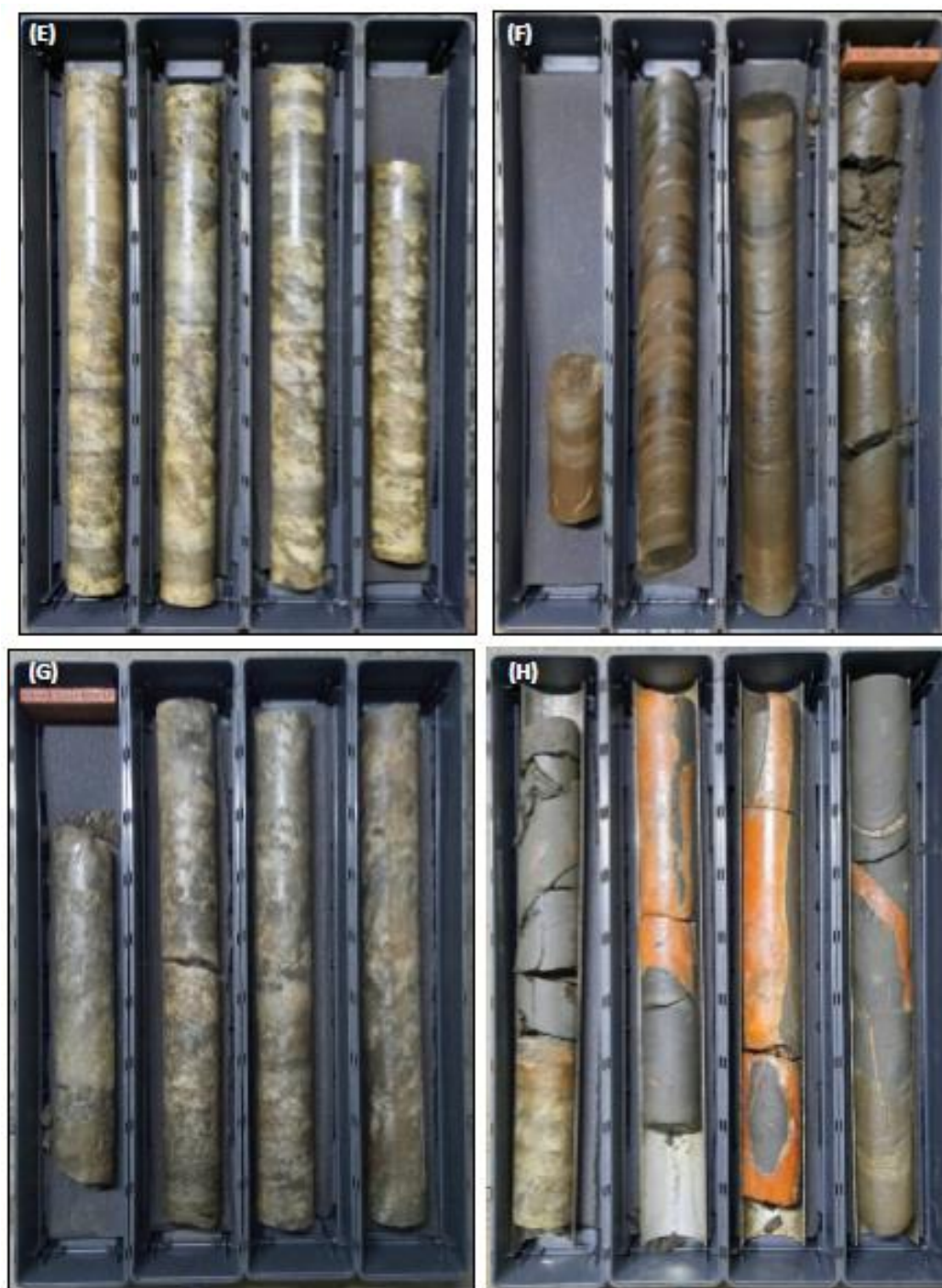
Figura 24 - (E) Intervalo de 997,27 m até 1.000,68 m exibindo camada de sal-gema cinza amarelado mosqueado; (F) Intervalo de 1.007,20 m até 1.010,30 m exibindo folhelho preto ( S_0 = 45^\circ a 55^\circ ), com intercalações centimétricas de sal-gema cinza, níveis carbonáticos e arenito cinza a siltoso de matriz carbonática; (G) Intervalo de 1.189,97 m até 1.193,25 m exibindo sal-gema impuro cinza a preto e; (H) Intervalo de 1.141,37 m até 1.144,60 m exibindo folhelho/argilito negro com fraturas preenchidas por sal-gema impuro.
