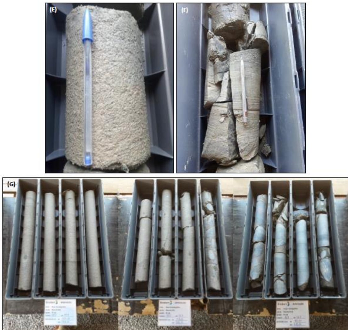
Figura 18 - (E) Arenito cinza com variações esverdeadas, médio a grosso, aspecto maciço (428,85m); (F) Plano de fratura em arenito com passagens de folhelho (446,80m); (G) continuação do pacote litológico acima, mostrando a sequência de testemunhos de 475,27m até 485,57m (caixas 456 até 467), exibindo o topo do fluxo de detritos, caracterizados por arenitos médio a grossos, em passagem gradual na base para conglomerados.
